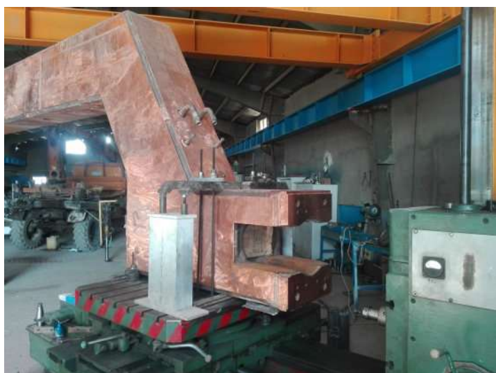
آخرین مراحل آماده سازی قبل از تحویل الکترود آرم کوره قوس الکتریک
